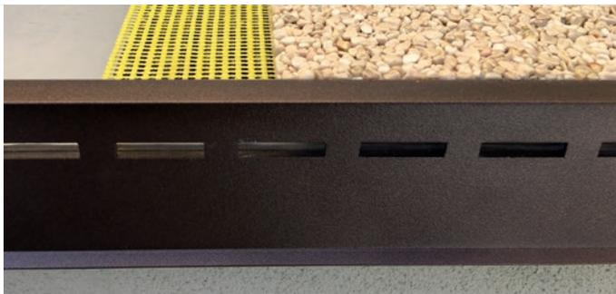
Für offene Belagsränder, sorgt das spezielle Drainrandprofil „RabaFin® DRP“ mit 23 mm oder 16 mm Aufbauhöhe für einen saubereren Balkonrandabschluss. Dieses besitzt Entwässerungsschlitze, wodurch das Wasser von der Flächendrainage HydraDrain® schnell und sicher abgeführt werden kann.
